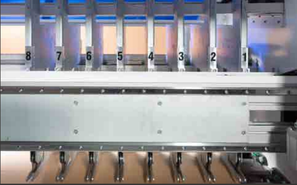
Dikeyde 8 Bıçak standart, 16 bıçağa kadar opsiyon 8 Blades standard in vertical, option up to 16 blades
